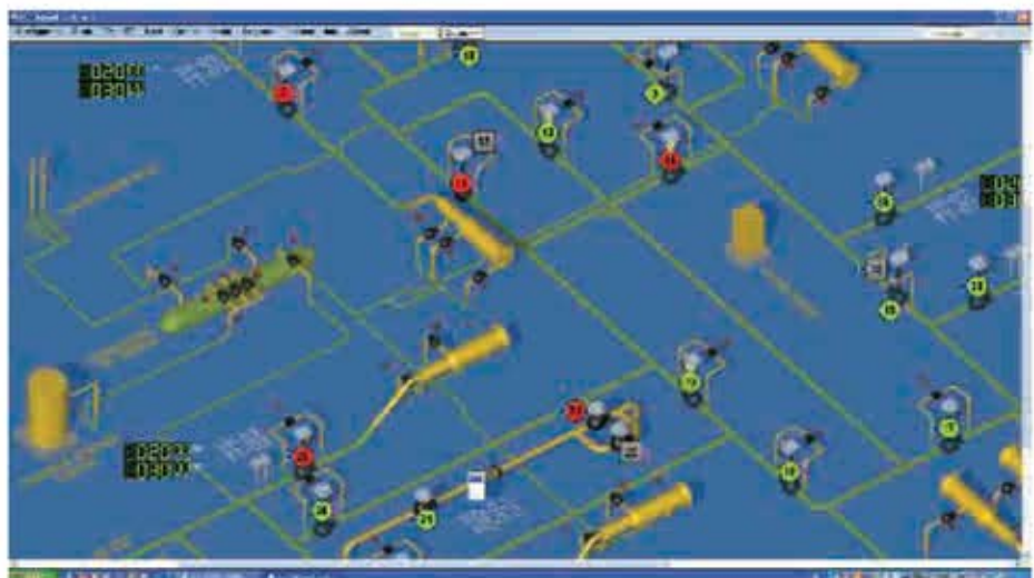
Fig. 1. Schema sinoptică tridimensională pentru un nod tehnologic de transport gaze naturale
